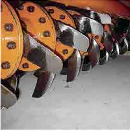
**Rotoregge (Klingenrotor) mit S-förmigen Werkzeugen.**
