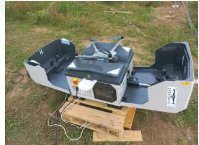
Drohnen Box - Drohne fliegt selbstständig eine Route (Zaunanlage) ab
