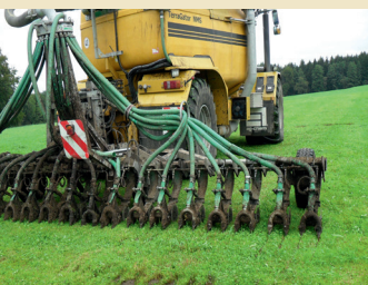
Abb. 5: Bei der Gülleausbringung mittels Gülleinjektion werden die Ammoniakemissionen um ca. 80 % reduziert.
