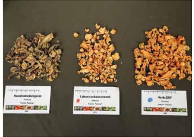
Schon auf den ersten Blick traten die Farb- und Qualitätsunterschiede (hier bei Karotten) bei den verschiedenen Trocknungsverfahren im Vergleichsversuch an der Versuchsausßenstelle Zinsenhof der HBLFA Schönbrunn zutage. (© Wolfgang Palme)
