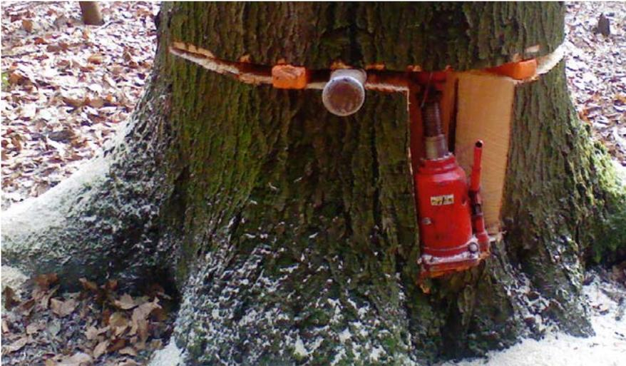
Hydraulische Fällhilfe im Einsatz
