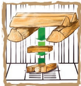
Befuerungselement auf dem Scheitholz positionieren
