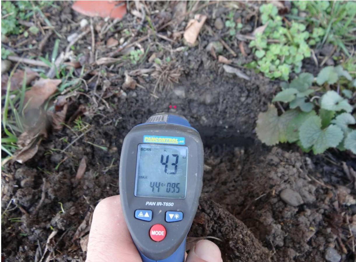
Messung der Bodentemperatur vor der ersten Bearbeitung im Frühjahr in der geplanten (seichten) Arbeitstiefe – noch keine Bearbeitung bei 4,3°C Bodentemperatur!
