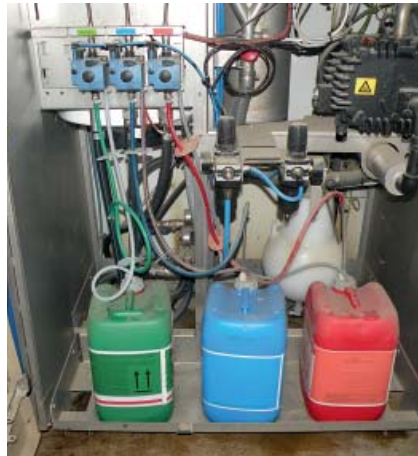
Bild 18: Der Verbrauch von Reinigungs- und Desinfektionsmittel kann Anhand des Füllstandes und der Aufwandsmenge über einen definierten Zeitraum überwacht werden. LK Stmk
