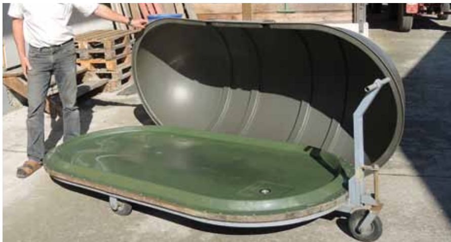
Mobiler Lagerbehälter (Quelle: LK NÖ).
