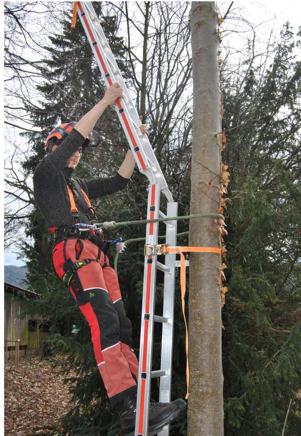
Hohe persönliche Sicherheit bietet das Steckleitersystem nach Distel. Mit der sogenannten Distelleiter können Wertastungsdurchgänge ergonomisch und vor allem Z-Baum-schonend durchgeführt werden.
