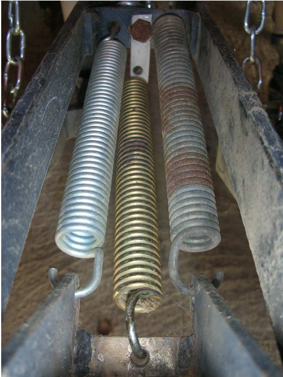
Abb.5: Dritte Zugfeder an den Schleppscharen zur Erhöhung des Schardruckes
